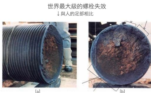
圖2.3 拉桿的破裂表面 (b圖: 內部發生疲勞開裂)
