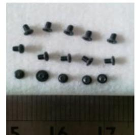
圖 4. 滲碳熱處理微形螺絲工件
