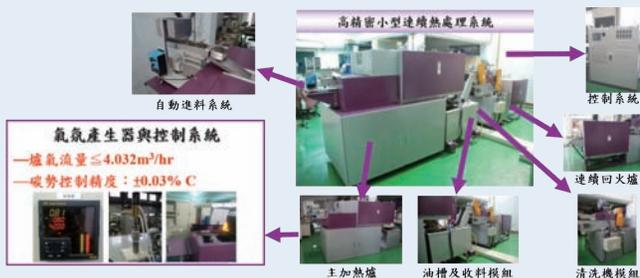
圖 1. 原型設備包括微型工件的自動化進料系統、微型工件的淬火冷卻系統、火爐氣體生成裝置和監控整合系統。
