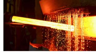
接著做回火和伸線,其中包括把鋼材加熱到將近低臨界溫度。
