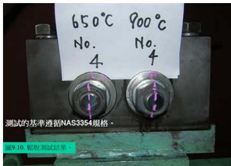
圖9.10. 鬆脫測試結果
