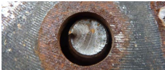
圖1. 車輪螺柱的金屬疲勞斷裂面
