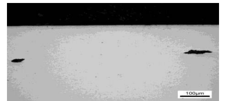
圖10 車削缺陷金相觀察含有夾渣
