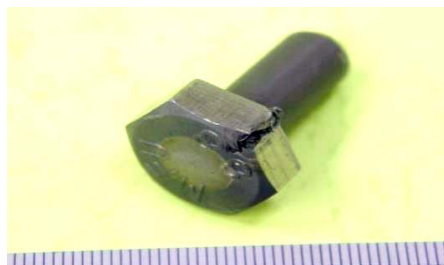
圖1 六角頭螺絲表面冷鍛(打)裂外觀
