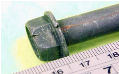
圖5 六角凸緣螺絲表面冷鍛(打)裂外觀
