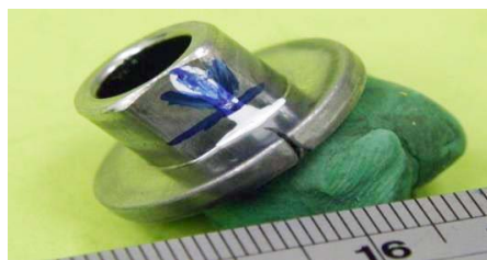
圖3 凸緣螺帽表面冷鍛(打)裂外觀
