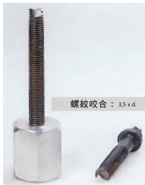
圖2. 預想中的螺栓在3.5 x 直徑的螺紋咬合位置斷成兩半。
