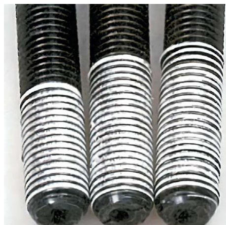
圖3. 鋁製內螺紋上發生滑牙的位置在2 x 直徑、2.5 x 直徑、2.75 x 直徑的位置。
