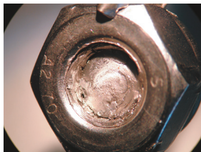
圖八 A2 鋼製螺帽「冷焊接」不良情形
