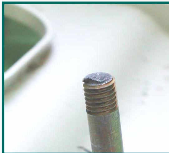
圖3 破裂方式由牙谷往心部成長
