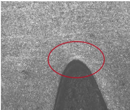
圖5 原廠件螺紋牙谷處有流線組織（圓圈處）
