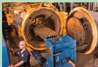
圖6 典型的真空爐 (照片由Solar Atmospheres公司提供)
