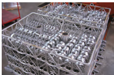
圖2 熱處理後的膝關節植入物
