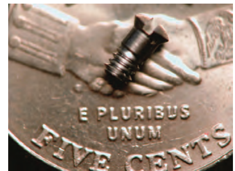
圖5 熱處理後的髖關節修復螺絲 (照片由Midwest Thermal-Vac公司提供)
