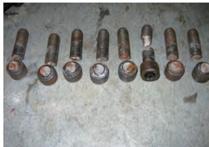
斷裂表面可透露疲勞斷裂過程中，哪支螺栓最早故障，哪支最晚。最早發生疲勞的螺栓，其蔓延的斷裂區域最廣；其次是第二支螺栓，其蔓延的斷裂區域沒那麼廣；以此類推，直到最後產生疲勞者，則會發生延展性伸張（右側第3枚內六角圓頭螺栓）。
