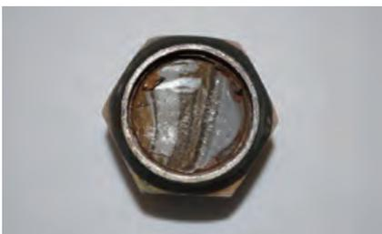
腐蝕性環境會造成「應力腐蝕裂縫」，使得顆粒邊界受到化學侵蝕。靜止積水會構成電解電池，導致氫脆化作用。
