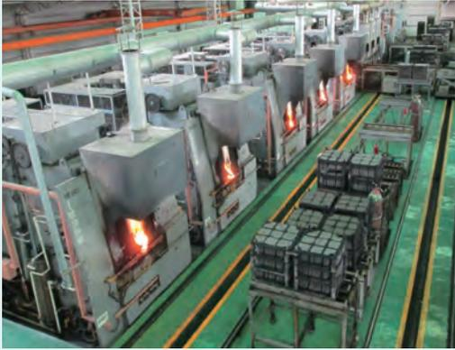
退火爐, 熱處理爐, 淬火爐
