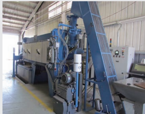
圖2、振動篩底式爐鈦合金扣件熱處理(前端) (照片提供: DF Industries)
