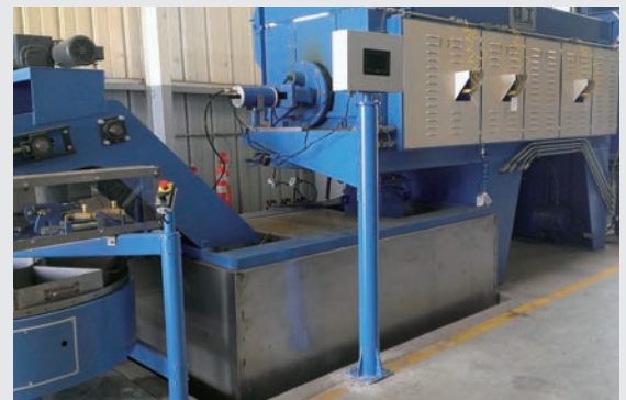
圖3、振動篩底式爐鈦合金扣件熱處理(後端) (照片提供: DF Industries)
