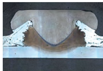
圖5 EJOT® EJOWELD® CFF鋁/高強度鋼接合範例
