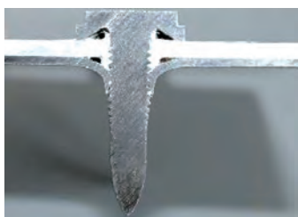
圖4 用於鋼料上的EJOT® FDS® 鋁件
