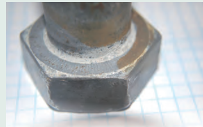
圖五：脊狀結構咬住了螺栓頭部
