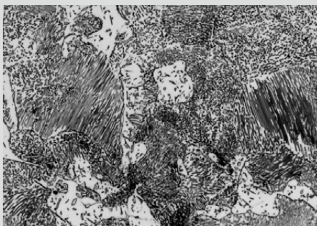
圖5. 球化不良含粗大碳化物金相組織
