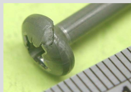
圖3. 螺絲頭部冷鍛(打)裂外觀
