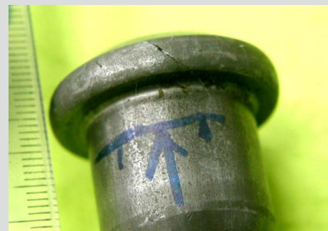
圖6. 螺栓冷(鍛)打硬裂外觀
