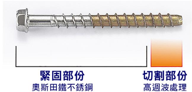
世鎧蔡松峻經理表示：「300系列奧斯田鐵系不銹鋼擁有良好的抗腐蝕性，運用於戶外時，可大幅增加使用壽命及避免螺絲鏽蝕失效所導致之安全性問題，尤其在高腐蝕地區更能凸顯其優異；尾部使用可硬化處理之碳鋼，功用在於鎖入時的前導螺紋，避免不銹鋼螺絲本體因材料特性導致無法鎖入情況發生。」
