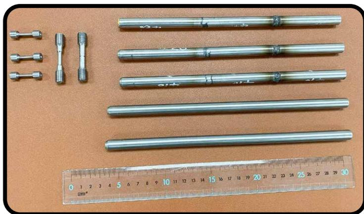
為驗證「不氫鋼」的耐氫性能，成大建立了全國少數可評估金屬氫脆的實驗室，以進行集氫處理與氫脆疲勞試驗。實驗結果顯示，「不氫鋼」的耐氫滲透效果遠優於其他工業級不鏽鋼。
