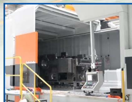
正曜目前已開發機型涵蓋 2 模至 8 模，為了因應客戶對自動化加工速度和效能等需求，也積極把 AI 融入產品設計領域（例如：機台偵錯功能），同時也針對舊機型做重新校正（例如：原本 1 分鐘可生產 240 支 M8 螺絲調校為 300 支），以及透過公母模外吊外調的方式來加快換模效率，從各方面滿足客戶對精度、速度和穩定度越來越嚴苛的要求。
