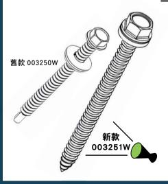
北美太陽能基礎設施供應商 Unirac 擁有北美太陽能支架市場 30% 的市佔,近期升級了其最常用的屋頂固定螺絲。新款003251W - DTD #14 x 3 // 自攻螺絲取代了之前的 003250W - #12-14 x 2.50 螺絲, 具備更銳 利的螺紋和尖端設計,安裝更輕鬆且固定更牢固,提升跨距表現。
